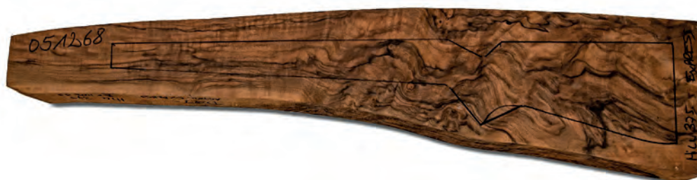
Foto Schaftkanten Abbildung zeigt Schaftrohling "Super Exklusiv" für Repetierbüchse
